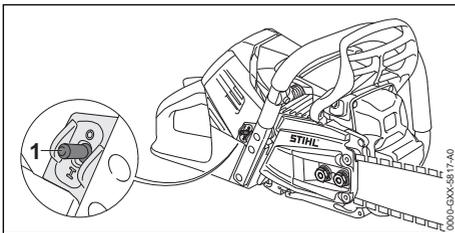
**1 Interrupteur de chauffage de poignées**
